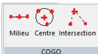
Les boutons **COGO** permettent d'activer les modifications COGO décrites ci-dessus pour la visée sélectionnée.
