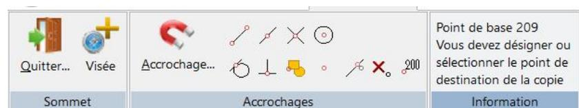
Il vous indique le point de base de la copie (qui est le nœud sélectionné de l'objet à copier) et vous invite à fournir le point de destination qui peut être défini par un clic dans la fenêtre dessin, une prise de mesure si vous êtes connecté à un appareil de
