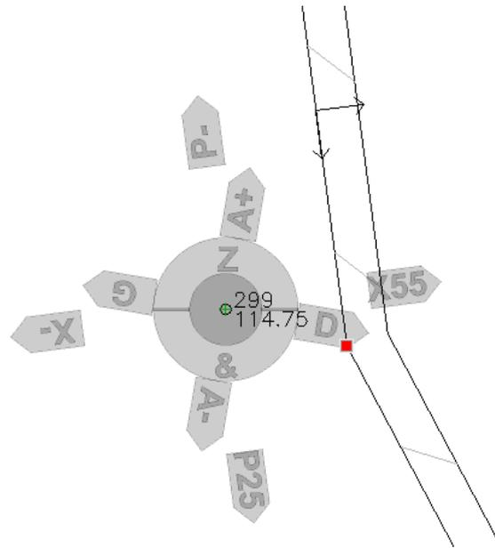
La figure est centrée sur la visée du carnet liée au nœud de l'objet topographique sélectionné (emplacement de la canne lors du relevé).
