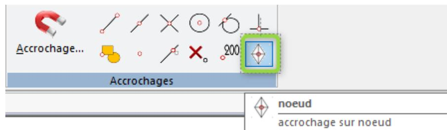
En particulier lorsque les coordonnées d'un nœud sont différentes de celles de la visée juste sur le deltaZ, l'accrochage 'nœud' permet de s'accrocher à la bonne altimétrie sur le nœud et non sur la visée.
