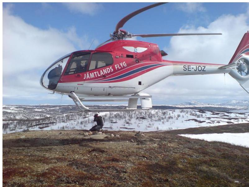
Figure 17 - Effet du rolling-shutter sur une prise de vue d'un élément rotatif rapide (source Wikipedia)
